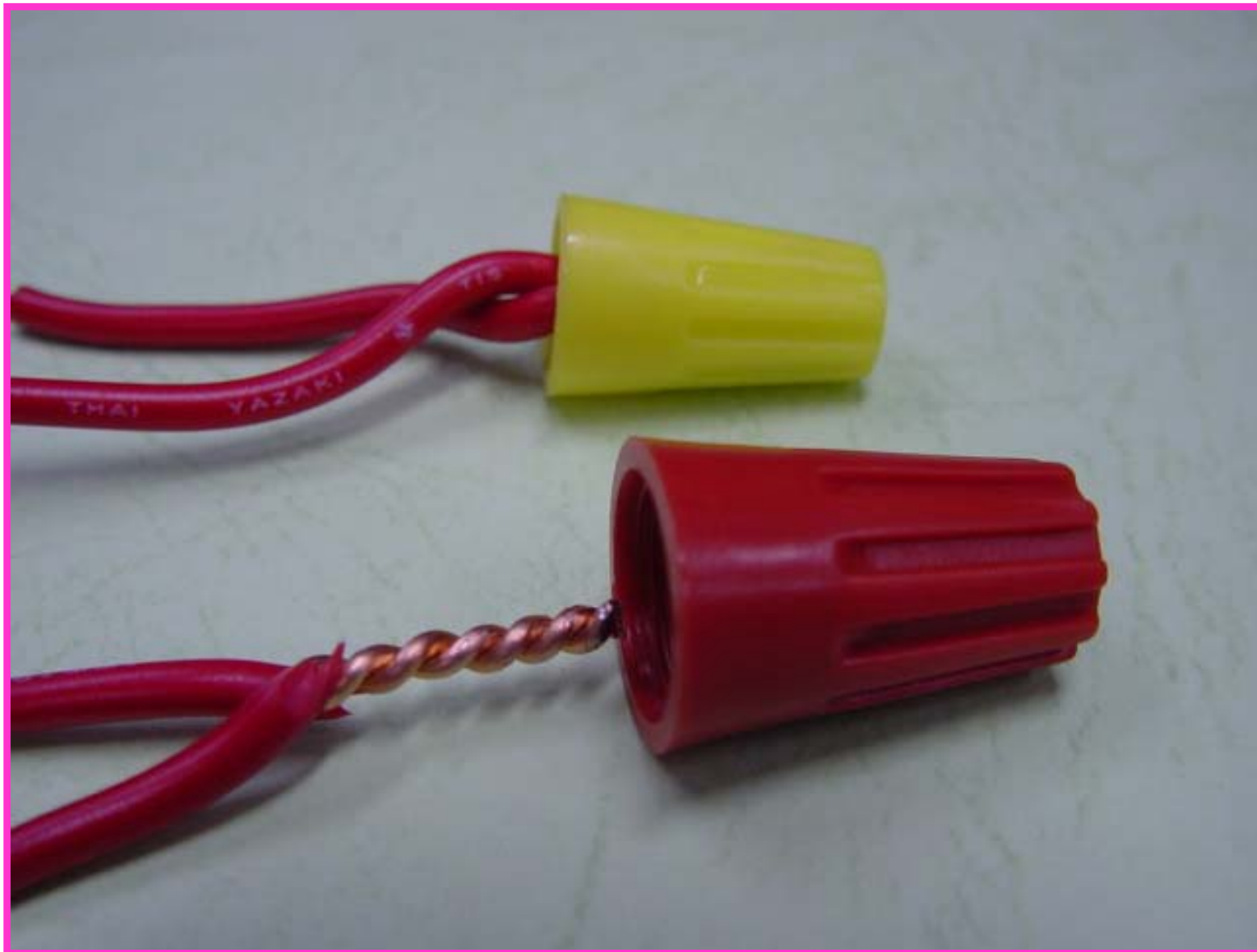
รูปที่ 4 แสดงการต่อสายด้วยไวร์นัท (Wire Nut)
